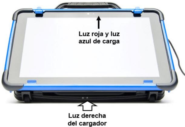
La luz roja indicadora de carga del Chat Fusion estará iluminada. Cuando la batería esté totalmente cargada, prenderá la luz azul de carga.
