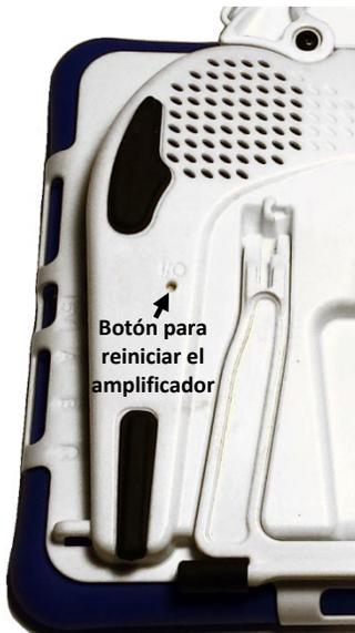
*Para apagar el amplificador:* Toque y sostenga el botón para reiniciar/encender y apagar el equipo (con el símbolo “I/O”) del amplificador hasta que prenda la luz ámbar y la luz azul. Cuando se apague la luz ámbar, suelte el botón.
