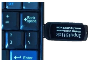
Exemple: InputStick branché sur le port USB-A d'un ordinateur portable
